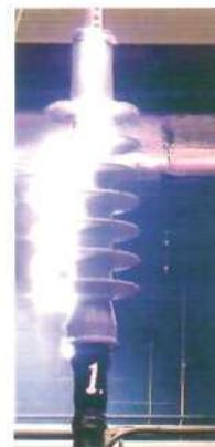
Электрический разряд на концевой кабельной муфте во время испытания.
